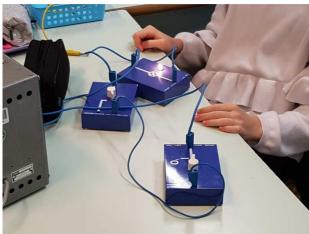
Die Kinder der 5c aus dem Schuljahr 2020/21 haben eine **Waschmaschinen – Schaltung** geplant und probieren sie jetzt aus. Die Lampe ersetzt die Waschmaschine. Sie geht erst dann an, wenn sie eingeschaltet ist und die Klappe geschlossen wurde.
